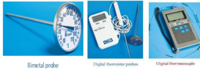
Gambar 12. Beberapa jenis termometer yang bisa digunakan untuk memonitor suhu pada makanan
